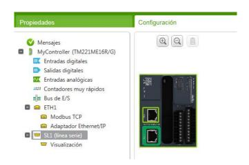
Se utiliza el puerto serie 1 porque dispone de alimentación de 5 V para el terminal, a través del pin 7
